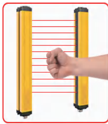
手掌检测用 最小检测物体 Φ25mm (光轴间距20mm)
